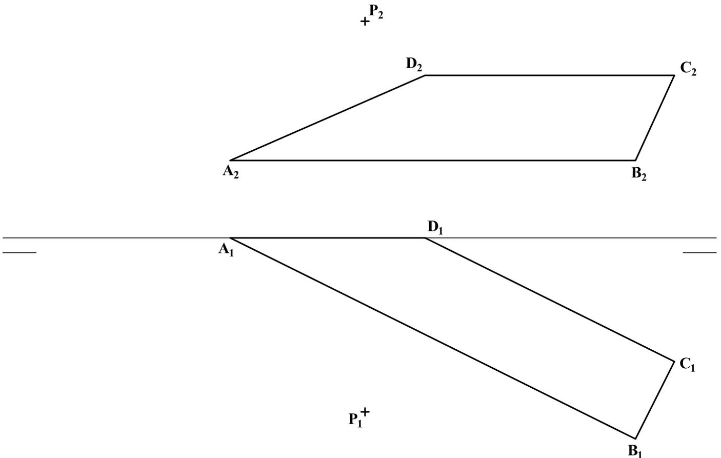
**B3.-** Completar la perspectiva cónica de la figura, en la que se ofrece la proyección de los puntos **A**, **B**, **C**, **D** y **E**, y se sabe que **AD** es una recta vertical paralela al plano de proyección.
